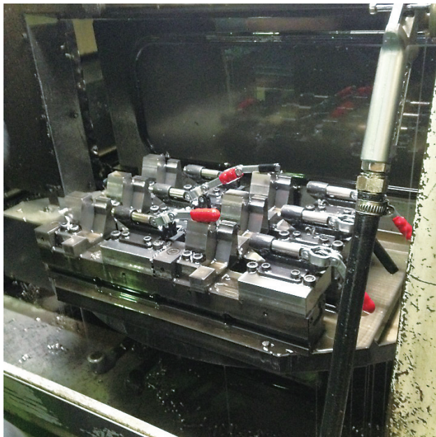
▲部品の向きを間違えるミスを防ぐために自社開発した治具
