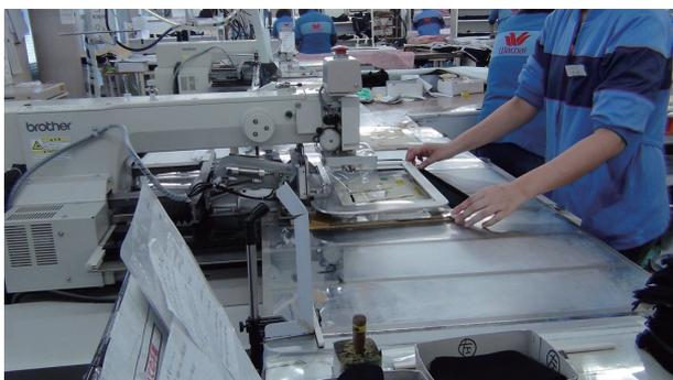
▲ 大型電子制御自動ミシンによる縫製作業
