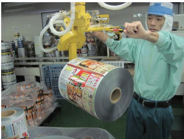
▲重量物移動補助器具などを用いて作業を行う様子
